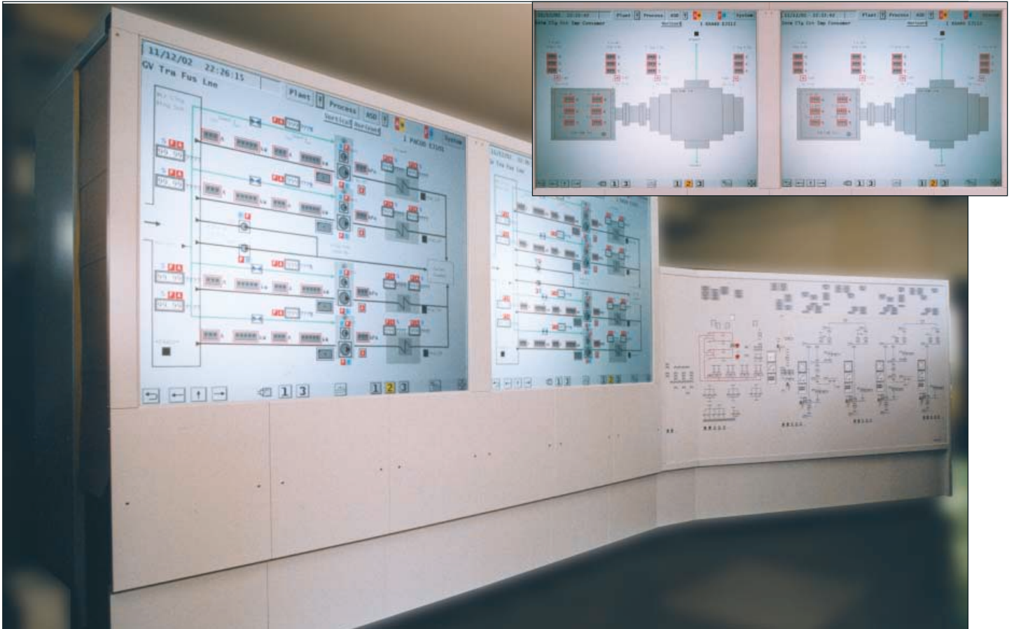
Simulator mit Grossbildrückprojektion 90° / Simulation with large screen projection 90°
